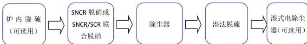
图 2 超低排放工艺流程 2（循环流化床锅炉）
